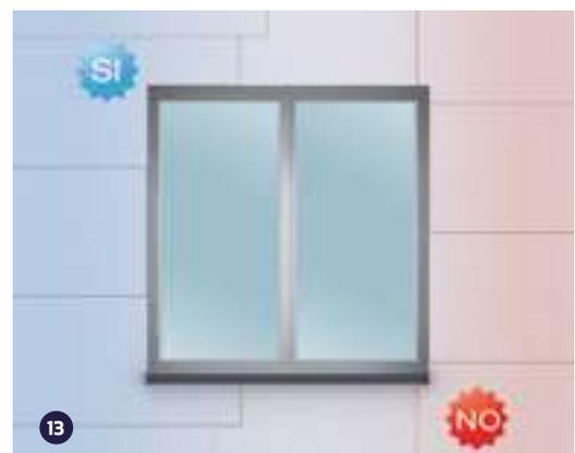
16 Aislar el recercado de puertas y ventanas (alféizar, jambas y dintel) para minimizar la creación de puentes térmicos y la descompensación en cuanto a transmitancia térmica entre unas partes de fachadas que están aisladas y otras que no.
