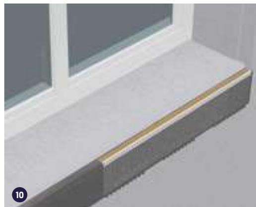
**10** Posicionar y embeber la malla del trozo de tira de **Perfil Alféizar**, previamente cortado a la medida exacta del hueco, sobre el todavía **Rhona T-700** fresco. También se tiene que quedar adherido la parte de pvc del perfil, éste en la posición horizontal. Dejar secar el mortero adhesivo un mínimo de 24 h.
